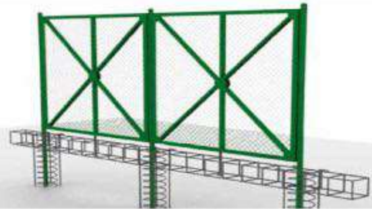
Figura 46. Cerramiento Tubería galvanizada y Malla eslabonada. Fuente Pag. Web IDRD.
