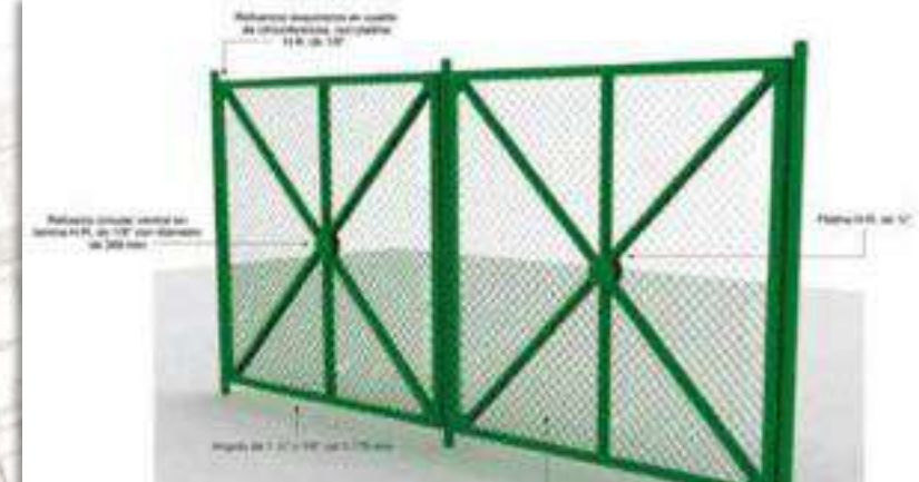
Figura 49. Cerramiento Tubería galvanizada y malla eslabonada paneles. Fuente: Pag. Web IDRD.
