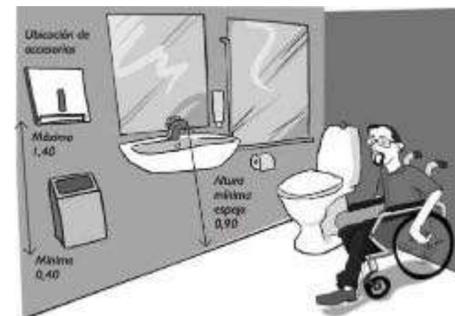
Figura 43. Detalles sanitarios. Fuente: Coldeportes.
