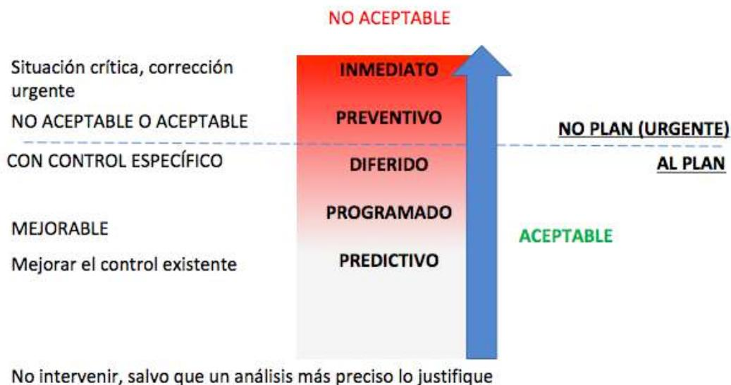
**Ilustración 18.** Nivel de aceptabilidad de acuerdo a los diferentes tipos de mantenimientos (Clasificación)<sup>22</sup>.
